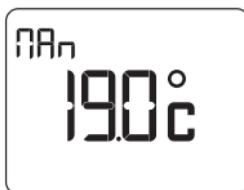
Bij de ingebruikname: Standaard temperatuurinstelling Eenvoudige modus = 19°C.
